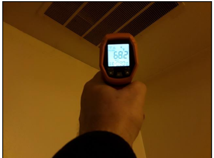
25. Heater return temp 68 deg
